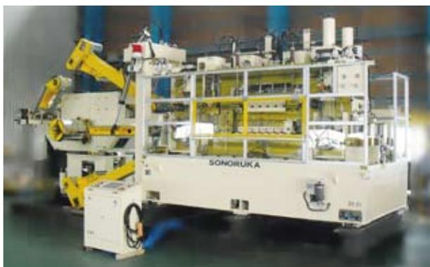
スリッターにより発生したバリ方向を同一にする為、アンコイラーからの繰り出しを上出し、下出しを実現。バンダーロールをワークロール入側に配置し、従来困難であったC方向のそりを軽減しました。
