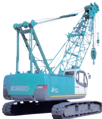
クローラクレーン
