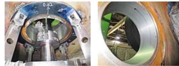
現地作業(フレーム精密穴加工)
