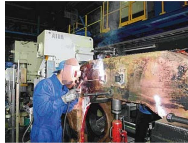
1600t スライド破損溶接修理
