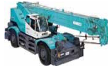
ラフテレーンクレーン
