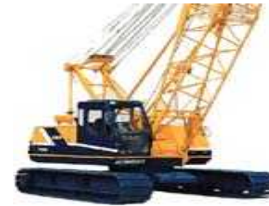
クローラクレーン
