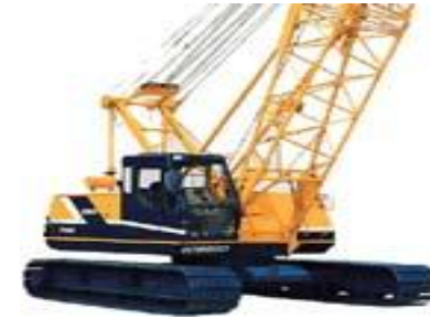
クローラクレーン
