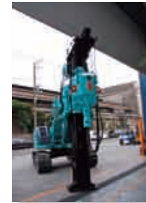
◀ 低空頭杭打抜機 全高: 4000mm 全幅: 2490mm 全長: 7500mm
