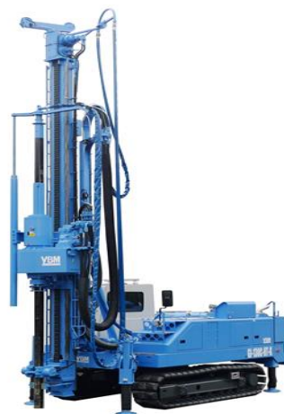
例②地盤改良機
