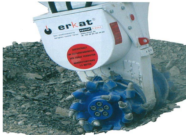
ERKAT社の掘削機用ドラムカッター
