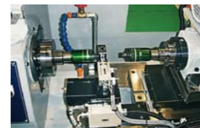
スパロール加工 (油圧単能機ベース専用機)
