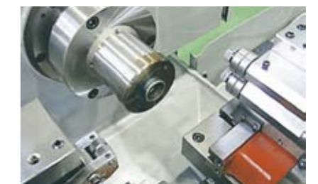
ローレット加工 (油圧単能機ベース専用機)
