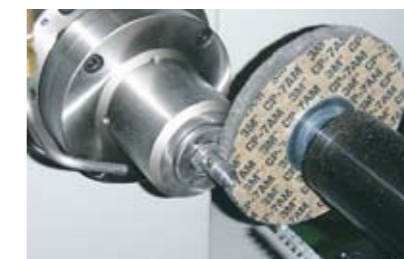
バリ取り加工 (油圧単能機ベース専用機)
