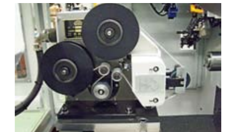
フィルム研磨ユニット取付 研磨加工 (FM機ベース専用機)
