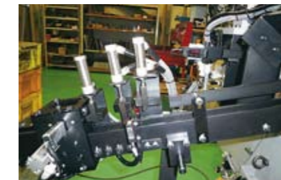
全長 ポカ除け装置 (GTセンサー)
