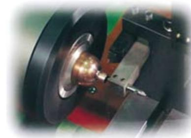
パイプ端成形の高速加工を誇る、パイプ端末加工機。供給ローダ付無人化運転可能なマシンや回転式パイプ絞りマシン、パイプ面取り機、リング挿入・カシメなど他工程や両端加工が可能なものなど、さまざまなニーズに対応できる加工機を数多く製造しています。
