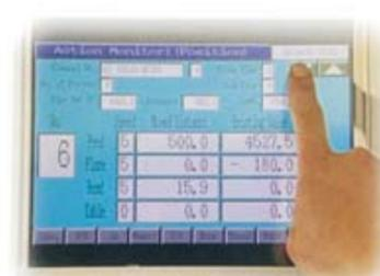
曲げパイプの形状・精度などをCMOSカメラにより計測ブース内のパイプを瞬時に測定、コンピューター上でパイプ加工をシミュレーションする、3次元パイプ測定機。千代田CNCパイプベンダーとのオンライン化可能で一貫した生産体制をシステム化し、ご提供しています。3次元測定機の測定データはプリントアウトして検査証に利用できます。
