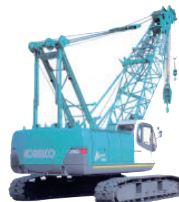
クローラクレーン
