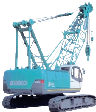
クローラクレーン
