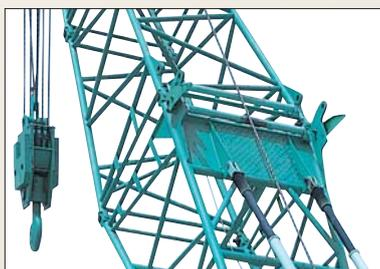
■ 中間ブーム背面にタワージブ上部スプレッド用レールを設置し、組立時に補助クレーンなしでスプレッドの移動を可能に
