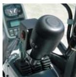
■巻上グリップのトップの触感で感知できるドラム回転感知システム(オプション)
