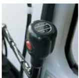
■操作レバーから手を離さずにON/OFFできるグリップ一体型の微速制御スイッチ
