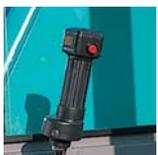
■旋回操作は反力感知機能付き油圧パイロット方式
