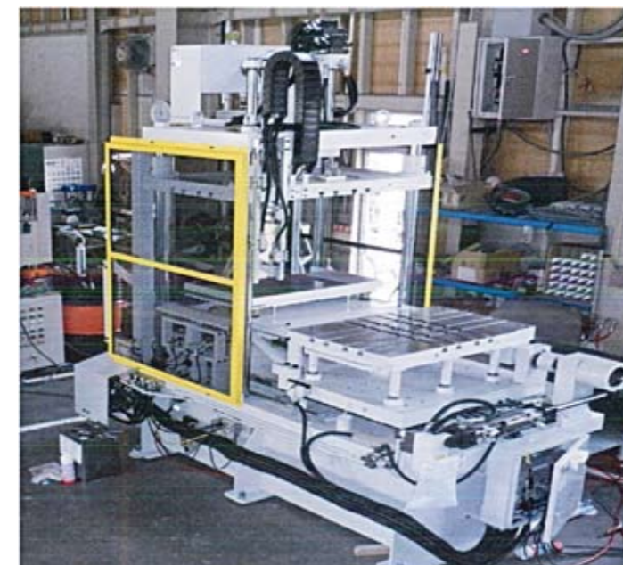
反転スライドテーブル付油圧トリミングプレス30TON
