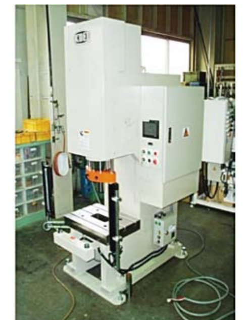
油圧サーボプレス30TON KUS-30
