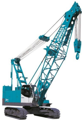
例①クローラクレーン
