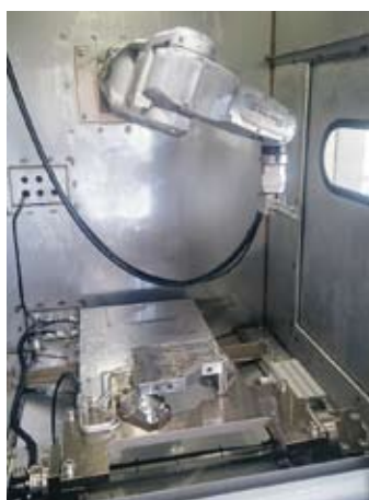
(6軸多関節ロボットがあらゆる角度を狙い洗浄します。)
