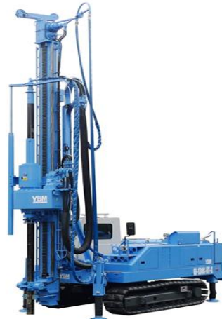
例②地盤改良機
