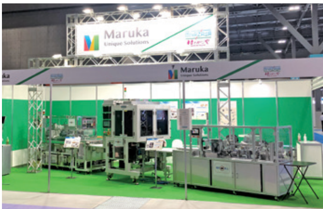
ミヤザワ サンドイッチ製造ライン 左奥から 第一工程「立型丸刃スライサー」3斤パンスライス 耳切りステーション 配列コンベヤ 第二工程「超音波ハーフカット機」 第三工程「密閉式サンドイッチ包装機」
