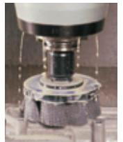
ウェット加工時のクーラント供給例
