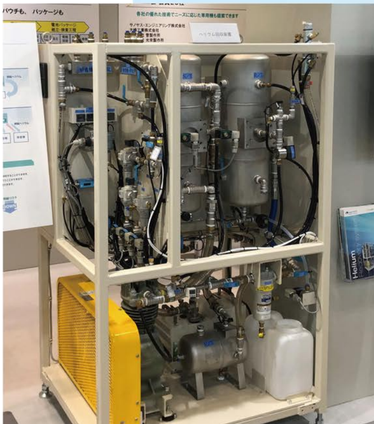
ヘリウム回収装置
